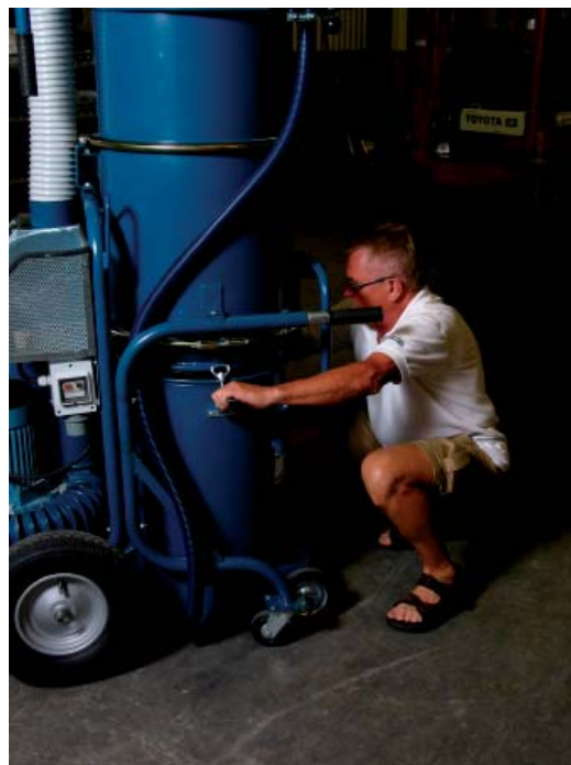
Behållaren sätts fast på maskinen med hjälp av de båda spärrlåsena.
